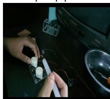
Gambar 2. Pemasangan Buzzer pada Papan Akrilik
