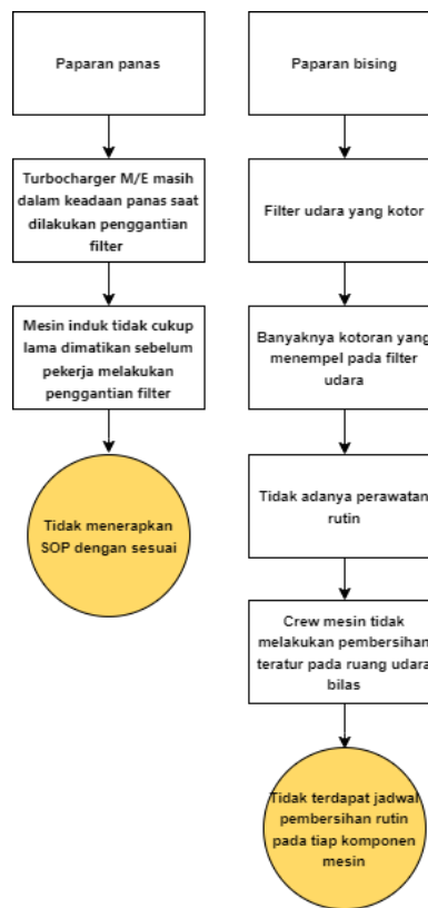
Gambar 3. RCA pada Proses penggantian filter pada turbocharger M/E
