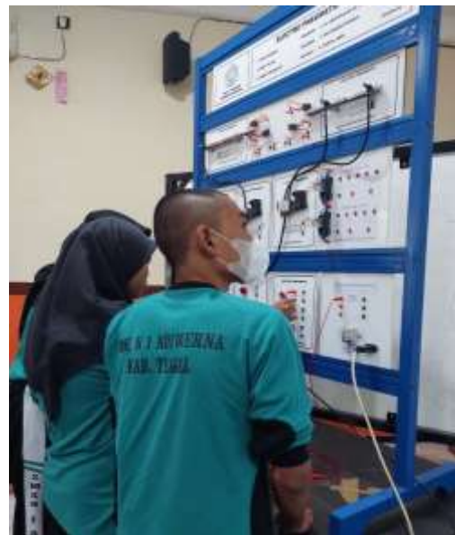
Gambar 9. Siswa-siswi bergantian mempraktikkan pemasangan wiring pada trainer elektro pneumatik
