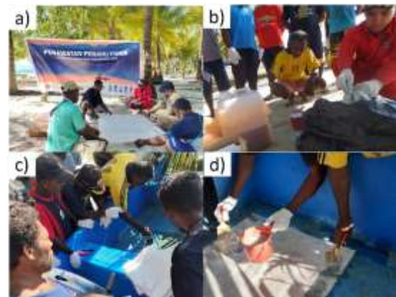
Gambar 4. a) Pengukuran dan pemotongan material material Chopped Strand Mat 450 maupun Woven Roving 600. b) Masyarakat membantu Taruna Politeknik KP Sorong dalam melakukan pencampuran pada resin yang digunakan. c) Proses pembersihan bagian atas kapal yang akan dilakukan penambalan. d) Proses pelapisan resin dan serat sebagai material utama untuk menambal kapal nelayan yang rusak.
