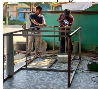
**Gambar 4.** Proses pembuatan alat pengasap ikan lele
