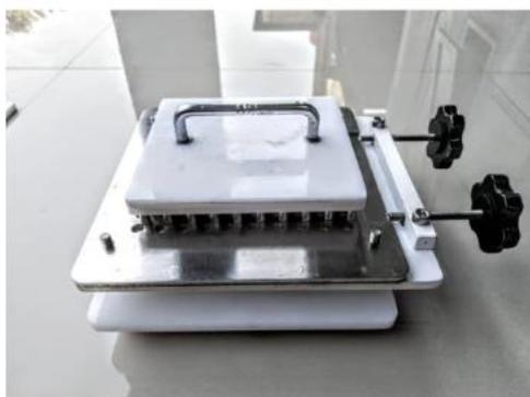
Gambar 6. Mesin pembuat kapsul daun kelor
