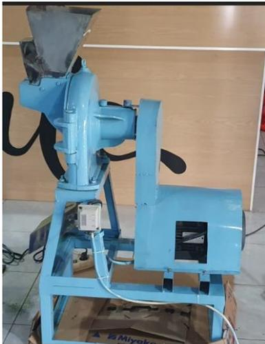
Gambar 4. Mesin pembubuk daun kelor
