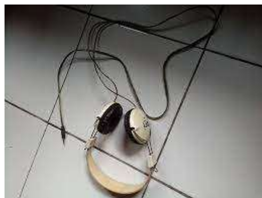
Gambar 5 Penyuar telinga sebagai komponen luaran (audio output)
