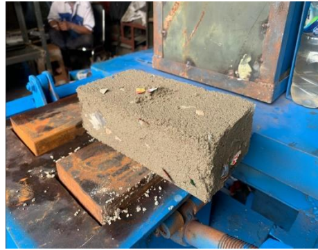
Gambar 3. Hasil uji coba paving Blok
