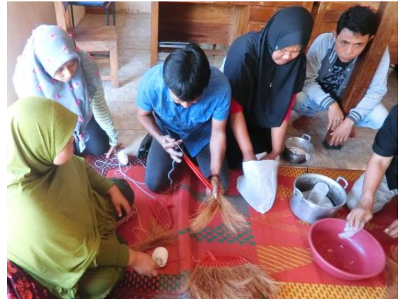
Gambar 7. Proses perakitan sapu dari sabut kelapa pada klakop menggunakan tali dan pengait
