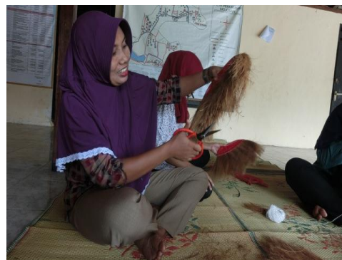
Gambar 11. Proses perapian ujung sapu dengan menggunakan gunting
