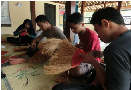
Gambar 13. Pemasangan gagang sapu pada klakop
