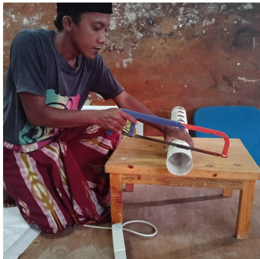
Gambar 5. Meratakan ujung pipa
