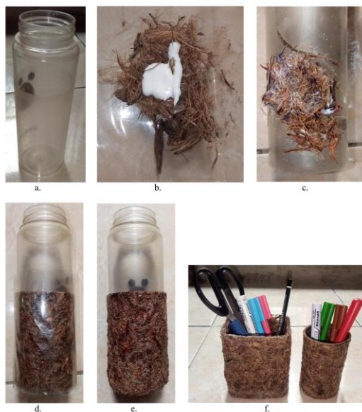
Gambar 3. Proses Pembuatan ATK, pembuatan pola (a), Pencampuran Fiber Mesocarp dengan Additive PVAc (b), Perakatan pada Pola (c), Pelapisan dengan Mika Plastik sebagai Perataan (d), Perapihan ATK (e), ATK bentuk Bulat dan Persegi (f).
