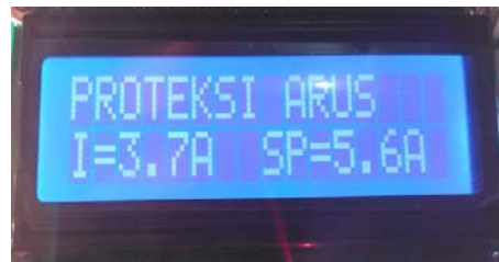
4.2 Pengukuran Beban Lampu 50 Watt DC 12 Volt
