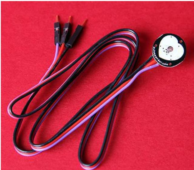
Gambar 2.8 Pulse sensor atau sensor detak jantung
