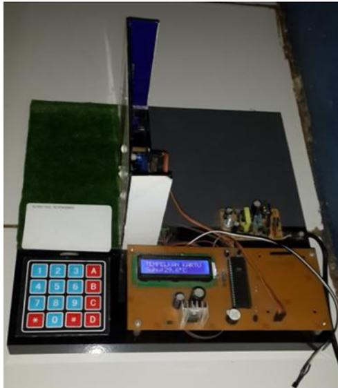
**Gambar 7** Purwarupa Sistem Keamanan Menggunakan RFID Dan Password
