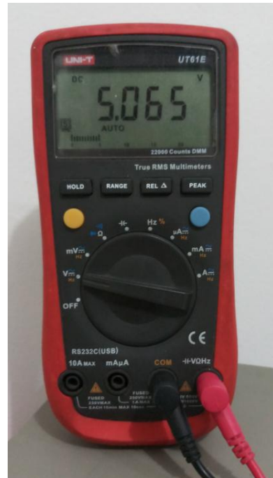
Gambar 16. Pengukuran tegangan keluaran
