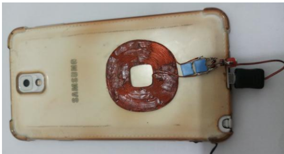
Gambar 14. Pemasangan Receiver pada Handphone
