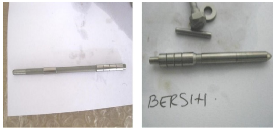
Gambar 8 Pin injector pada solar dan Jarum nozzle pada solar bersih
