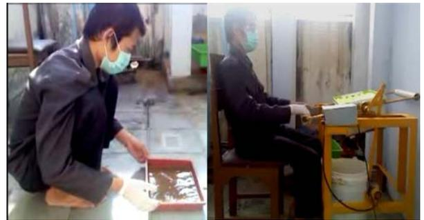
Gambar 10. Posisi kerja sebelum dan setelah perancangan
