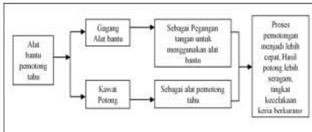
Gambar 4. Analisa Fungsi Alat Bantu
