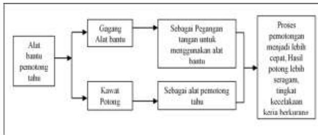
Gambar 4. Analisa Fungsi Alat Bantu
