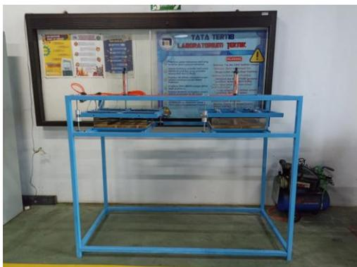
Gambar 11. Hasil Prototipe Alat Pemotong Tahu
