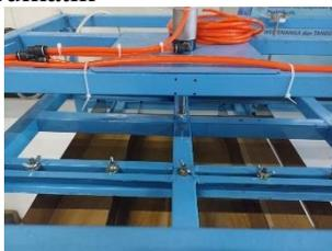
Gambar 6. Pemasangan Ujung Piston dan Frame Pisau
