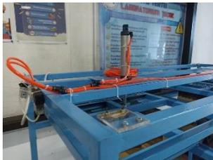
Gambar 5. Pemasangan Silinder Pneumatik
