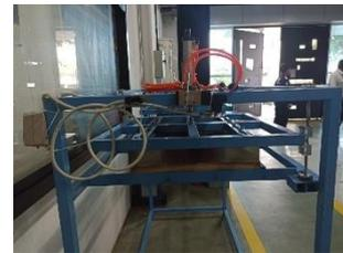
Gambar 7. Pemasangan Solenoid Valve 5/2
