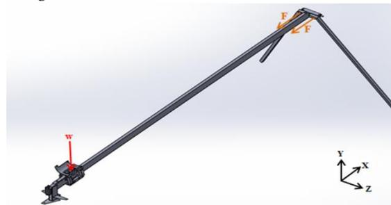
**Gambar 9.** Kondisi pembebanan sistem pelontar
