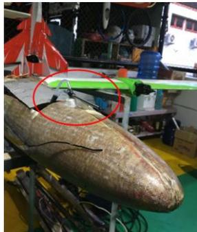
**Gambar 13.** Air speed sensor pada wahana
