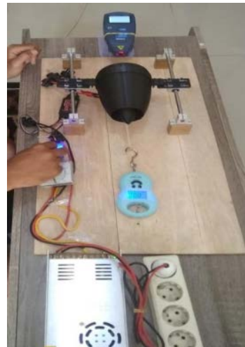
Gambar 6. Proses pengujian EDF
