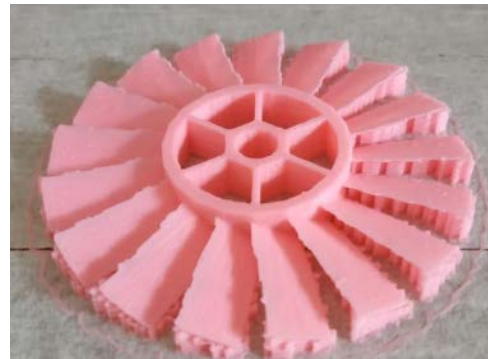
Gambar 9. Fan hasil cetak tiga dimensi
