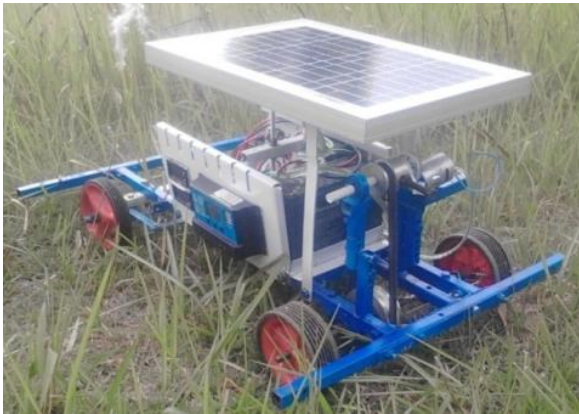
Gambar 5. Mesin pemotong rumput dengan sistem transmisi Pulley dan V-belt
