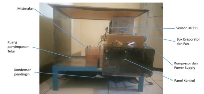
Gambar 9. Tata letak komponen dalam prototipe
