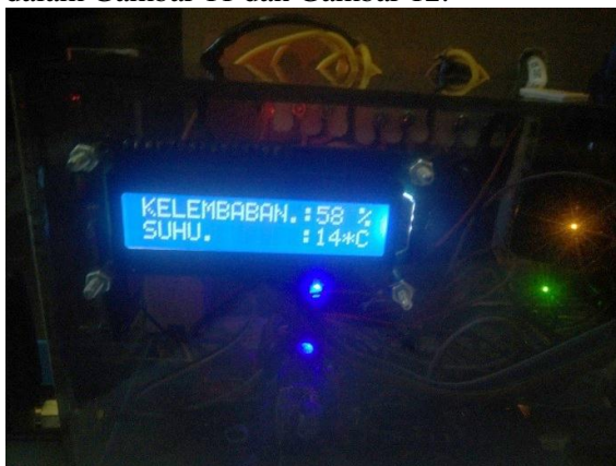
Gambar 11. Tampilan LCD untuk suhu 14°C dan kelembaban 58 %.
