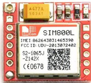
Gambar 7. Modul GSM SIM800L
