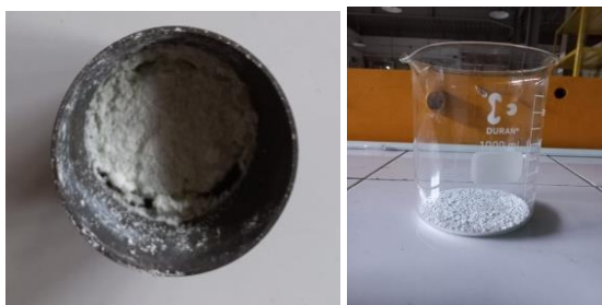
Gambar 2. Hasil peleburan dengan metode Fusi kaustik soda
