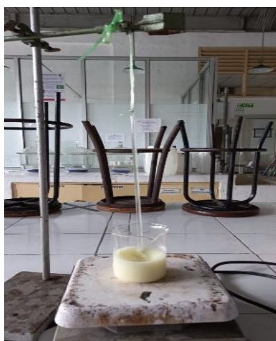
Gambar 3. Proses pelindihan dengan HCL 5M perbandingan 1: 10.
