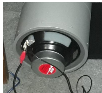
Gambar 5. Loudspeaker pengkonversi 6 inci dimasukkan pada salah satu ujung resonator.
