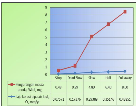
Gambar 9. Pengurangan massa anoda tembaga (Cu) RRY17 dan laju korosi pipa air laut (JIS F-0507)
