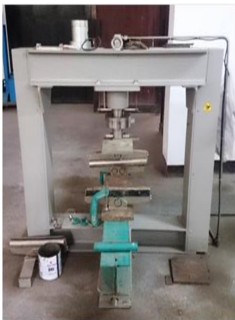
Gambar 6. Alat uji kekuatan bending menggunakan alat bernama CONTROLS, Model 50-C121.
