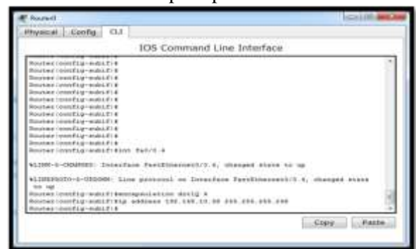
Gambar 22. Konfigurasi interface VLAN 4 pada Router
