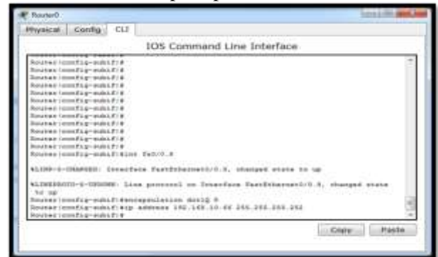
Gambar 26. Konfigurasi interface VLAN 8 pada Router
