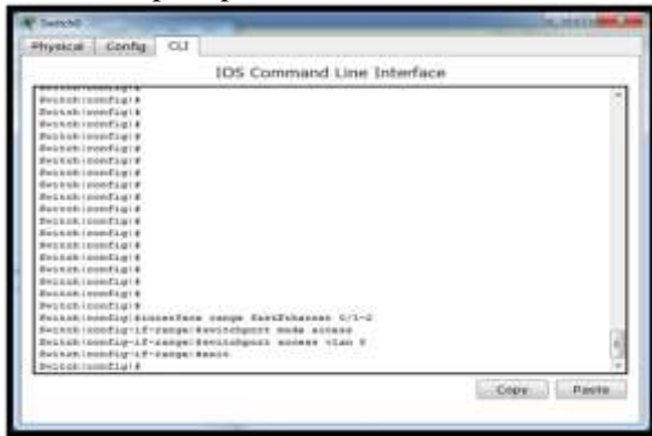
Gambar 17. Konfigurasi switchport VLAN 8
