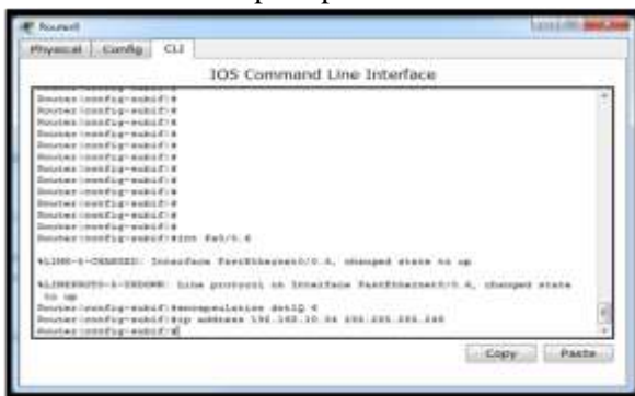
Gambar 24. Konfigurasi interface VLAN 6 pada Router
