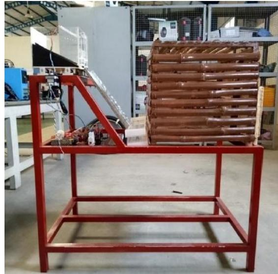
**Gambar 6.** Hasil prototipe alat pengontrol pakan ayam berbasis web menggunakan *NodeMCU*
