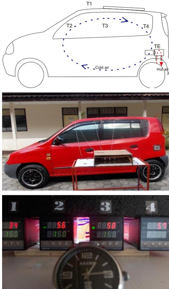
**Gambar 3.** Penempatan thermo-electric dan termokopel
