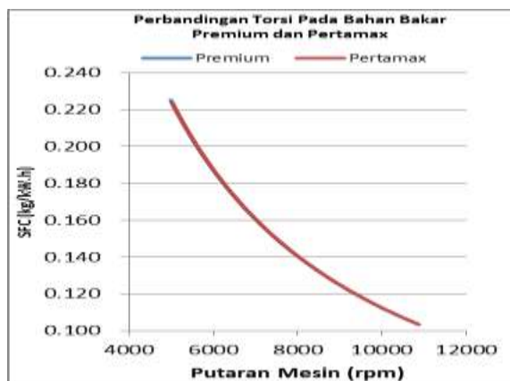
Gambar 4.3. Grafik perbandingan konsumsi bahan bakar spesifik (SFC) yang dihasilkan pada variasi bahan bakar
