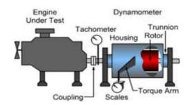
Gambar 4. Skema pengujian dynamometer
