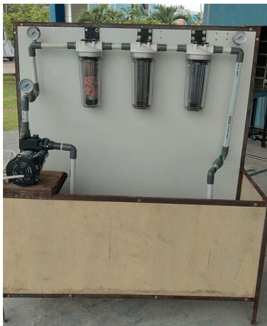
**Gambar 3.** Alat penjernih air portable dengan pengujian skala laboratorium
