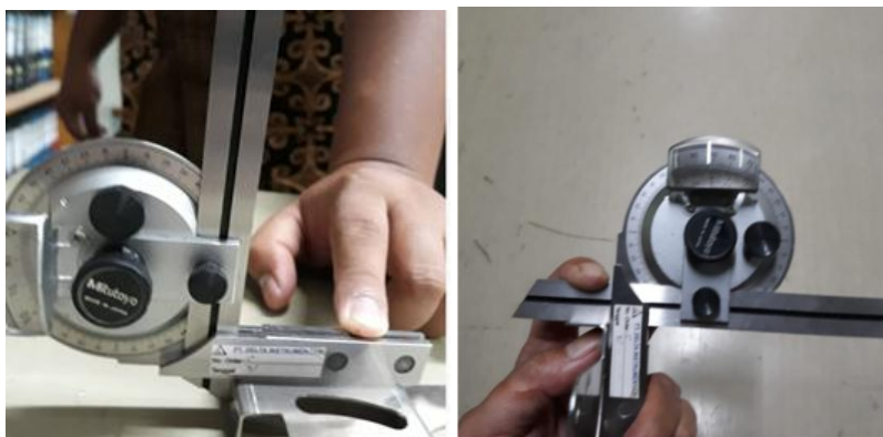
Gambar 6. Pengukuran sudut bending dengan menggunakan bevel proractor
