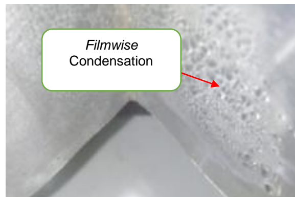
Gambar 3. Pembentukan filmwise pada penangkap uap model segitiga
