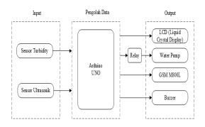
Gambar 1. Blok Diagram
