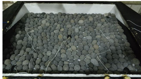
Gambar 6. Penyusunan sensible heat storage materials pada solar air heater
