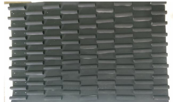
(a) (b) Gambar 2. Staggered turbulators dengan jarak tiap turbulator yaitu 2,5 cm dalam bentuk (a) eksperimen dan (b) modelling
