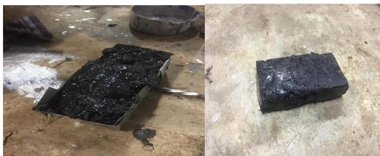
**Gambar 9.** Hasil Pencetakan *Paving Block*
