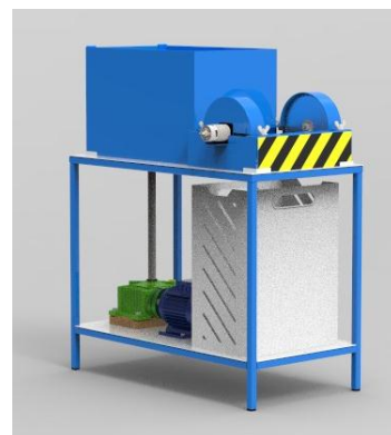
Gambar 13. Mesin pembuka kaleng limbah bahan berbahaya dan beracun (B3)
