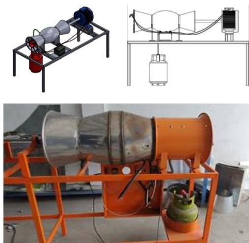
**Gambar 4.** Desain Mikroturbin Gas Baru
