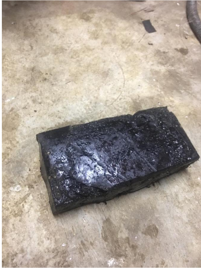
Gambar Produk Paving Block Berbahan Dasar Limbah Plastik
