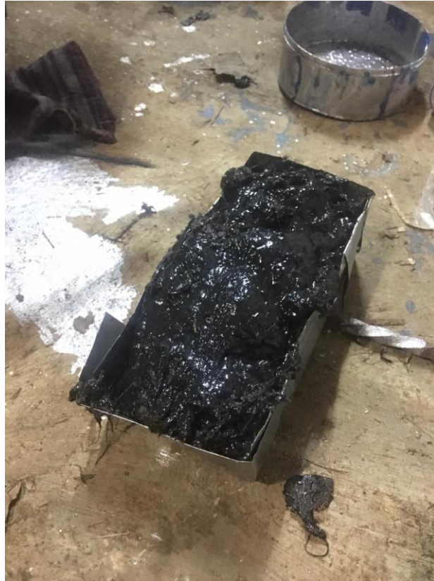
Gambar Hasil Pencetakan Limbah Plastik Leleh ke Dalam Cetakan
