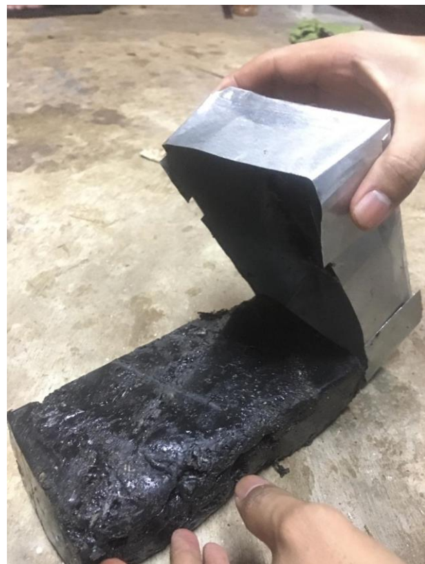
Gambar Pengeluaran Produk Paving Block Berbahan Dasar Limbah Plastik Dari Cetakan
