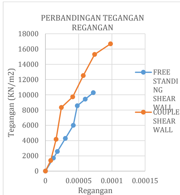
Gambar 14. Perbandingan Hubungan Tegangan Regangan antara Free Standing Shear Wall dan Couple Shear Wall
