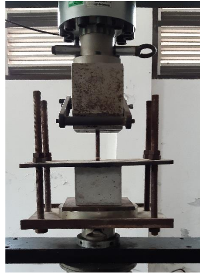
Gambar 5. Uji Tegangan Lekat dengan Pull Out
