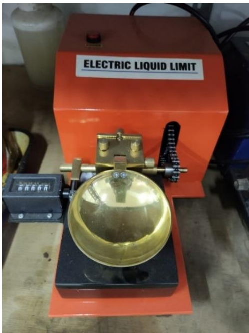
Gambar 1. Alat Cassagrande untuk Pengujian Batas Cair
