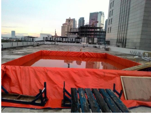
Gambar 8. Pembebanan uji statik dengan air
