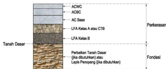
Gambar 1. Perkerasan Lentur Pada Permukaan Tanah Asli
