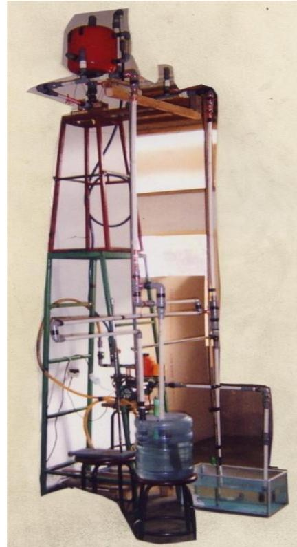
Gambar 2. Rancangan Pipa siphon dengan tinggi jatuh 3 meter
