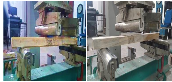
Gambar 6. Pengujian Kuat Lentur Balok Sandwich Panel HFRP Sengon dan Balok Kayu Jati
