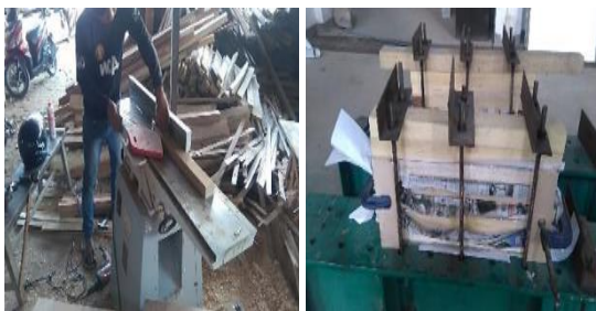
Gambar 5. Pembuatan Balok Sandwich Panel HFRP Sengon
