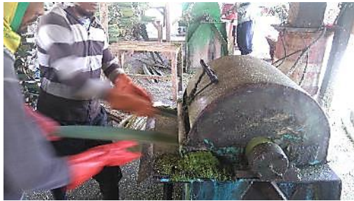
Gambar 1. Proses Ekstraksi Serat Daun Henequen
