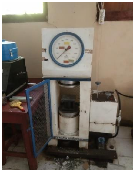
Gambar 3. Set Up Alat Uji Kuat Tekan
